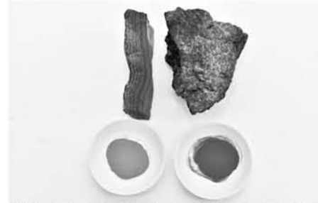
顔料(天然岩絵具)とその原石。左=緑青(緑色)、孔雀石=マラカイト、右=群青(青色)、藍銅鉱=アズライト
