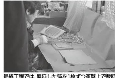
最終工程では、展延した箔を1枚ずつ革盤上で裁断し、竹箸で合紙に移す
