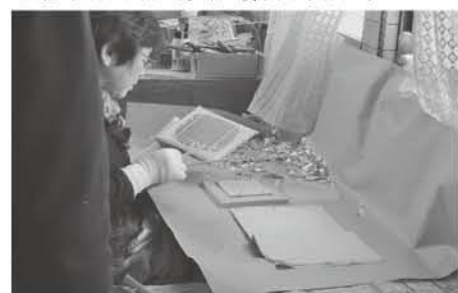
最終工程では、展延した箔を一枚ずつ革盤上で裁断し、竹箬で合紙に移す
