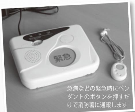
急病などの緊急時にペンダントのボタンを押すだけで消防署に通報します
